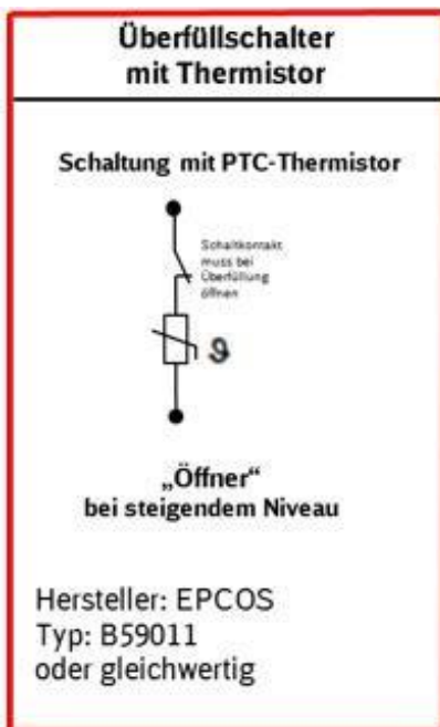
Bild 4: Grundschiung für Überfüllsicherungen im Fahrzeugtank (bspw. KROMA)
