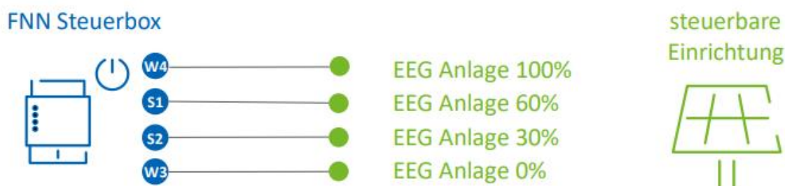
Abbildung 1: Anlagensteuerung mittels vier Relais (Quelle: VDE)
